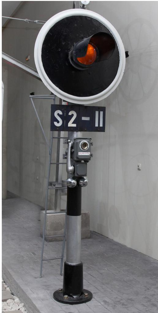
Señal monofoco de Control de Tráfico Centralizado
