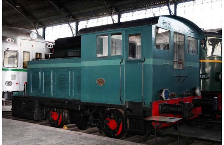
Locomotora diésel de transmisión mecánica fabricada en 1935 de forma experimental por La Maquinista Terrestre y Marítima (MTM), bajo licencia de la factoría alemana Deutsche Werke Kiel (DWK), con nº de fábrica 567. Formó parte de una serie de dos locomotoras que MTM entregó para pruebas a la Compañía MZA, donde recibieron la matriculación TM-201 y TM-202 (TM, de “Tractor de Maniobras”), existen dudas si precedieron a esas matrículas las 2201 y 2202.
