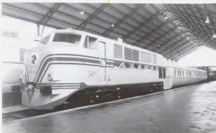
ques, con lo que se consigue una perfecta adaptabilidad en las curvas. El ángulo de ataque de la pestaña con el carril es negativo o nulo debido al sistema de construcción, circunstancia que elimina, prácticamente, los riesgos de descarrilamiento. Los remolques son de construcción ligera con un centro de gravedad muy bajo y reducida altura.
