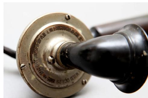
En la pieza metálica que sujeta la trompetilla del micrófono está grabada la inscripción “MADE IN SWEDEN BY A.B. L.M. ERICSSON & C° STOCKHOLM - PATENTED OCT 29 1895”, elemento inventado por Lars Magnus Ericsson en 1884 y patentado en 1895, el cual fue incorporando a modelos de teléfonos posteriores.
